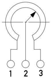
Zeigt die Wellenmarkierung in Richtung Anschluß 2, dann befindet sich der Schleifer auf elektrischer Mitte.
